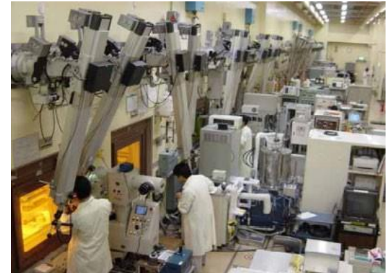
原子力科学研究所/燃料試験施設(RFEF)：軽水炉使用済み燃料やTMI-2燃料デブリに対するパッシブガンマ線測定等への利用を検討中
