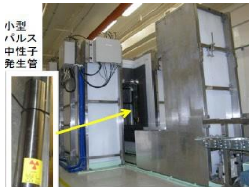
原子力科学研究所/NUCEF/BECKY にあるアクティブ中性子法装置(JAWAS-T)
