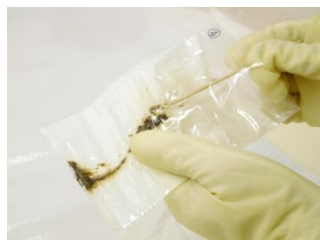
SEM (走査型電子顕微鏡) 試料の採取
