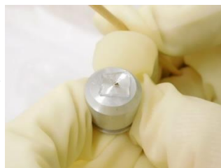
SEM (走査型電子顕微鏡) 試料の採取
