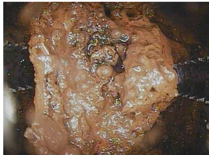
1 Fの2号機のペDESTAL底部の小石状の堆積物 (資料提供：東京電力)
