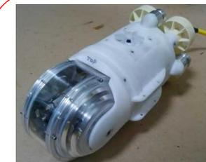
水中遊泳式遠隔操作装置
