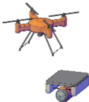
建屋地下滞留 水状況調査水中ロボット開発及び 調査
