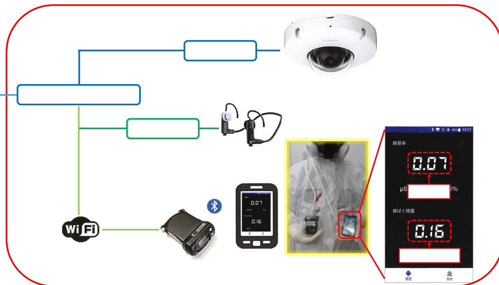
個人被ばく線量の遠隔監視システム（リモートモニタリングシステム）の概要
