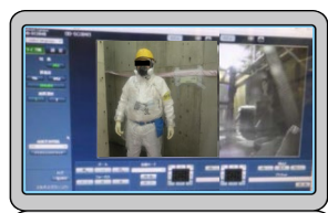
個人被ばく線量の遠隔監視システム（リモートモニタリングシステム）の概要
