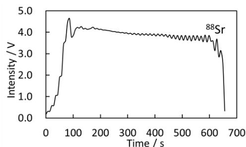
Fig. 1 Signal profile of ID-TE-TIMS
